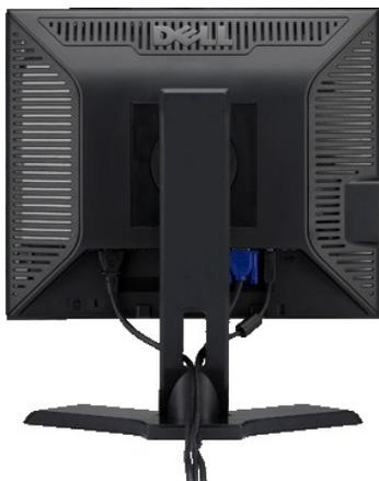
Dopo aver fissato tutti i cavi al monitor e al computer, (Vedere [Collegamento del Monitor](#)) usare il passacavi per organizzare i cavi in maniera ordinata, come mostrato sopra.
